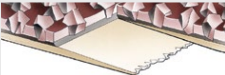
Typ 1: Überlappende Verbindung ohne Kornabschliff
