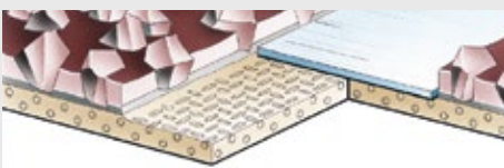
Typ 4: Gestossene Verbindung mit kornseitiger Spezialfolie
