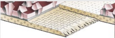
Typ 2: Überlappende Verbindung mit Kornabschliff
